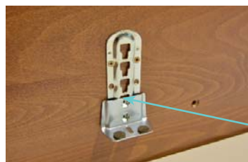
Variabilná výška roštu je nastaviteľná v štyroch krokoch po 24 mm
